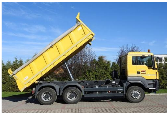
Rys. 4. Samochód samowyładowczy z plandeką np. do transportu ziarna
