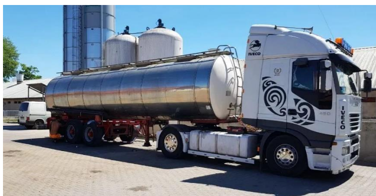
Źródło: https://www.otomoto.pl/oferta/magyar-sr3mef-cysterna-do-spozywki-4-komory-nierdzewna-cip-32000l-ID6DtxaY.html , 2020. Rys. 10. Cysterna do transportu mleka o pojemności 32 tys. litrów
