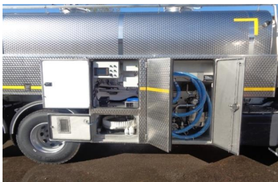
Źródło: https://pro-wam.pl/galeria-autocysterny/ , 2020. Rys. 9. System odbioru mleka w cysternie
