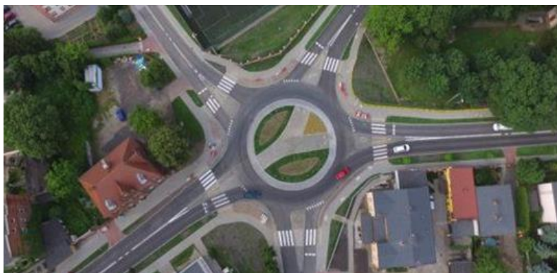
Rys. 12.6. Skrzyżowanie przystosowane do przejazdów transportów nienormatywnych
