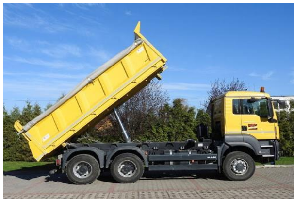
Rys. 13.4. Samochód samowyładowczy z plandeką np. do transportu ziarna
