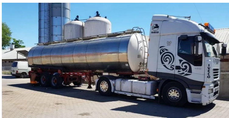
Rys. 13.10. Cysterna do transportu mleka o pojemności 32 tys. litrów
