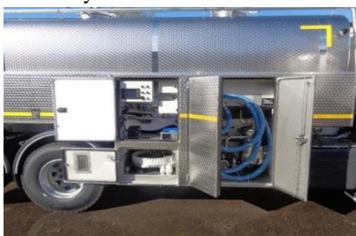
Rys. 13.9. System odbioru mleka w cysternie
