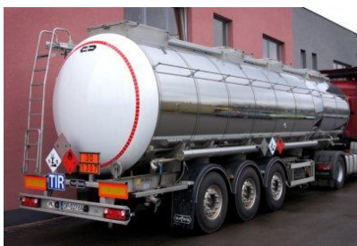
Rys. 20.4. Cysterna do przewozu płynnych materiałów niebezpiecznych
