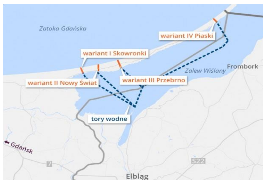
Rys. 25.5. Rozpatrywane warianty przekopu Mierzei Wiślanej
