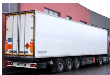
Rys. 20.5. IZO-kontener do przewozu stałych materiałów niebezpiecznych
