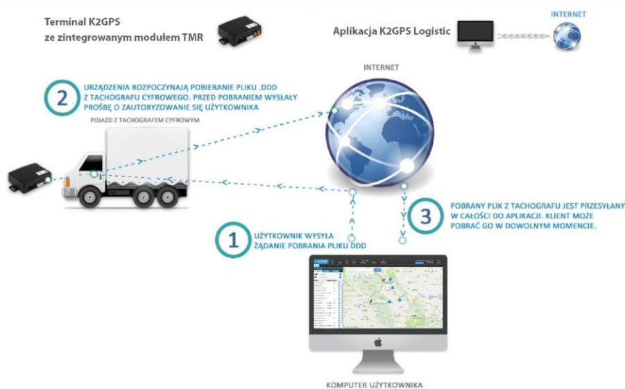
Rys. 3.44. Idea połączenia satelitarnego GPS - Internet - kierowca w systemie K2GPS
