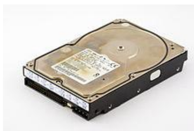
Źródło: Surowiecka C., praca zaliczeniowa z ćwiczeń przedmiotu „Procesy informacyjne w zarządzaniu”. Rys. 3.3. Urządzenie pamięci (15 GiB PATA dysk twardy - HDD- z 1999 roku)
