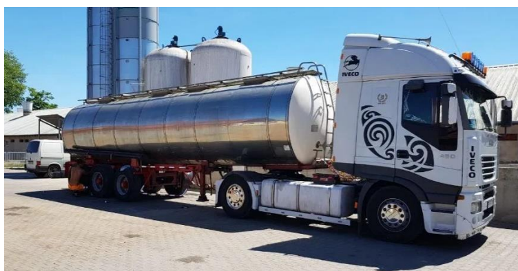
Rys. 12.10. Cysterna do transportu mleka o pojemności 32 tys. litrów
