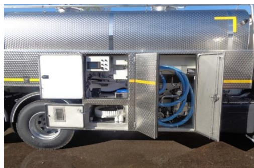
Rys. 12.9. System odbioru mleka w cysternie
