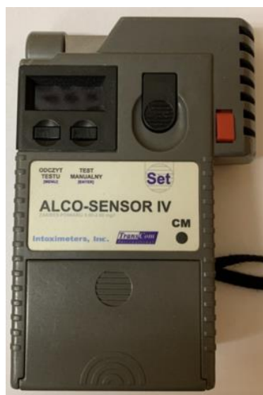
Rys. 13.3. Urządzenie do pomiaru zawartości alkoholu w wydychanym powietrzu Alco-Sensor IV CM
