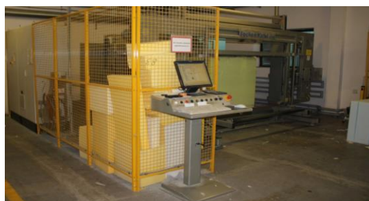
Rys. 7.6. Maszyna Fecken Kirfel służąca do rozkroju pianki poliuretanowej w blokach typu T-25
