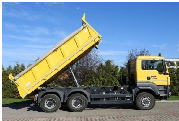
Rys. 12.4. Samochód samowyładowczy z planką np. do transportu ziarna
