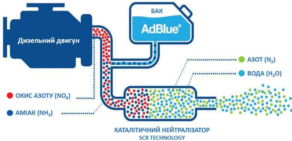
Рис.4. Принцип роботи технології SCR
