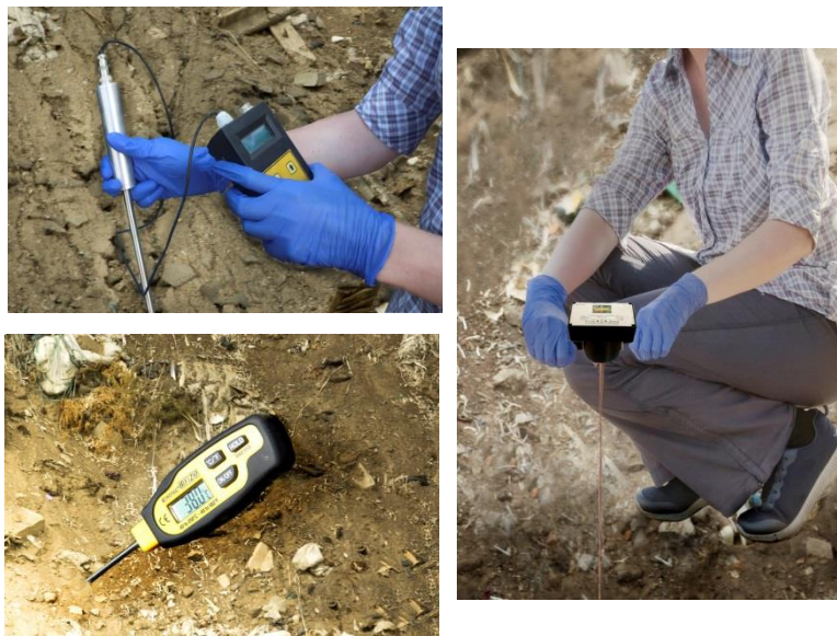
Рис. 1. Визначення фізичних показників звалищних ґрунтів на полігоні ТПВ
